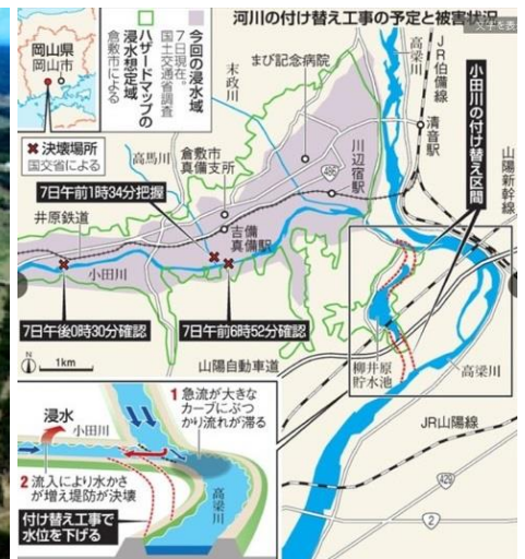
河川の付け替え工事の予定と被害状況(朝日新聞より)
