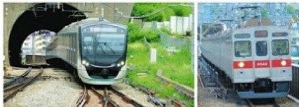
東急2020系電車は、長く主力だった8500系の約50%の使用電力で走行できる＝いずれも東急電鉄提供
