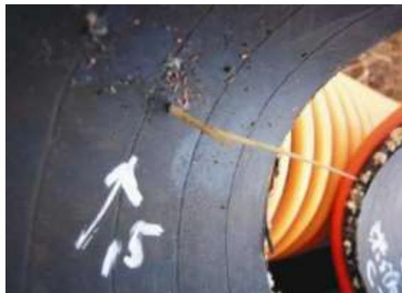
汚染水の移送に使うホースの内側。雑草のチガヤが刺さり、汚染水漏れが起きていた=東京電力提供
