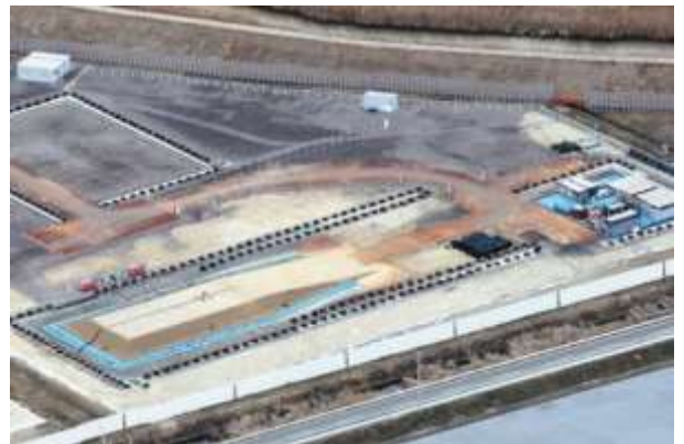
防潮堤を想定した汚染土の再利用試験＝南相馬市で、東京新聞社ヘリ「おおづる」から
